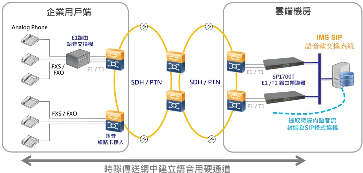
為了因應網路化、IP化的趨勢，台聯電訊打造可運行在 SDH/ PTN 承載網環境的 E1/ T1 閘道器，提取語音流後封裝為 SIP 格式，並讓語音註冊至 IMS (IP Multimedia Subsystem) 語音軟交換系統，或企業 IPPBX 語音軟交換系統。
